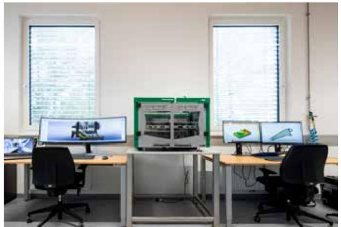
Abbildung 10: Hage 3Dp-A2 Großformat-Drucker (FDM-Verfahren für Kunststoff) im Rapid Prototyping Lab.
